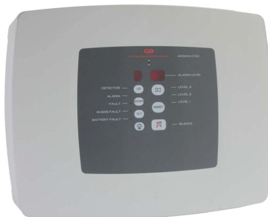
Jusqu'à 8 détecteurs peuvent être raccordés à la centrale. Chaque détecteur de gaz est connecté individuellement à la centrale par un câble de 3 fils. La distance maximale entre un détecteur de gaz et la centrale peut atteindre 170 mètres.
