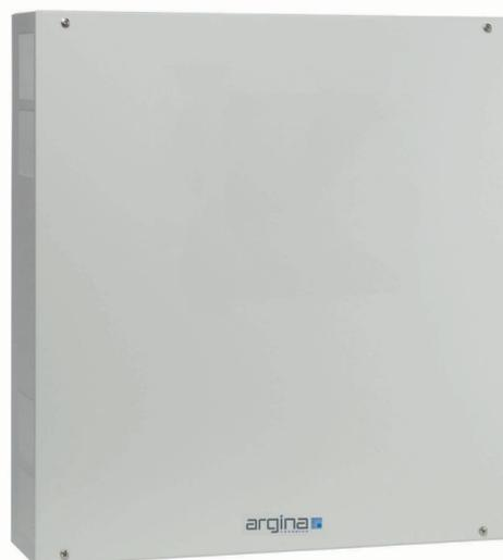
Une alimentation doit être placée si la consommation électrique totale de la centrale de détection d'incendie est trop élevée. En cas de portes magnétiques en grand nombre, l'autonomie de la centrale de détection d'incendie diminue ; en raccordant les portes magnétiques sur une alimentation séparée, l'autonomie de la centrale de détection d'incendie reste suffisante.
