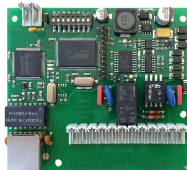
Sur les sites comportant différents bâtiments, les modules TCP/IP permettent de raccorder malgré tout au réseau toutes les centrales situées dans les différents bâtiments. Le module TCP/IP est, dans ce cas, installé dans la centrale de détection d'incendie GMC+ adressable et assure le raccordement entre eux des différentes centrales GMC+ et/ou panneaux de commande GMC+, via un réseau informatique ou via internet.
